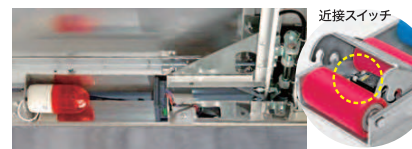
リア部に設置したパレットストッパーを掛け忘れている場合、ライトと音声により掛け忘れをお知らせします。
